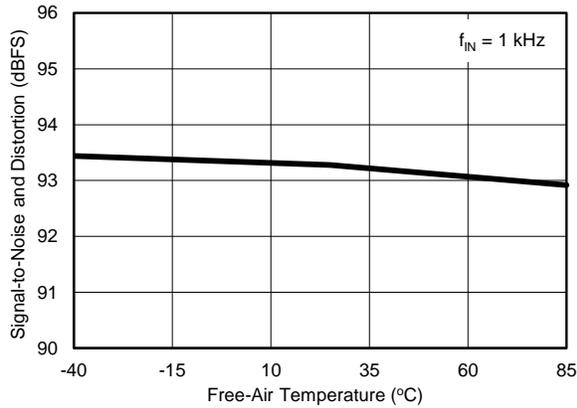
**Figure 24. SINAD vs TEMPERATURE**
