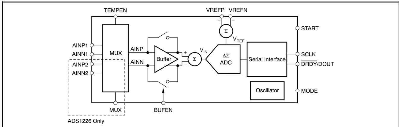
Figure 19. Conceptual Diagram of the ADS1225 and ADS1226
