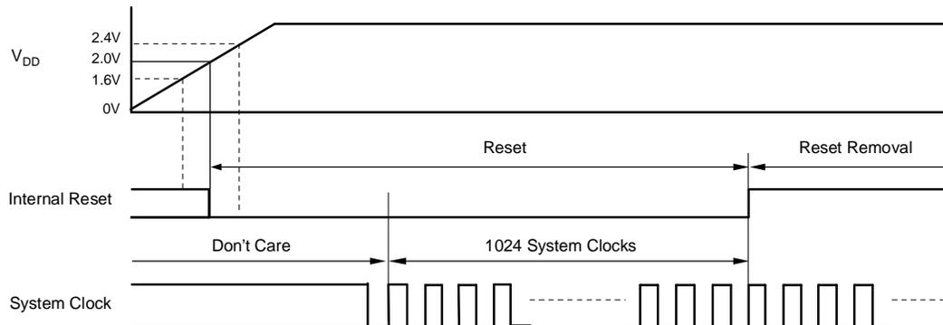
Figure 20. Power-On-Reset Timing
